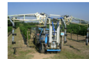
Fig. 20 : Pulvérisation sur le rang
